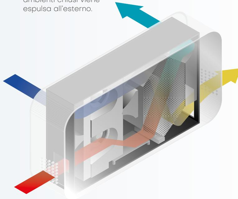
Lo scambiatore di calore riscalda l'aria pulita, recuperando fino al 91% del calore contenuto nell'aria esausta.
