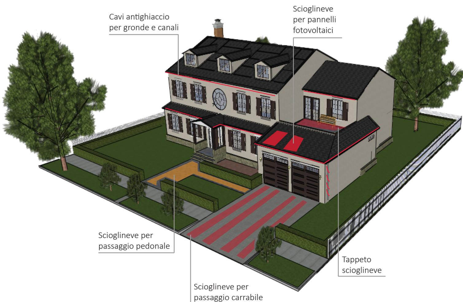
Thermoeasy offre diversi sistemi per ovviare alla formazione di ghiaccio e neve. Si tratta di sistemi radianti elettrici che possono essere controllati con centraline analogiche o digitali.
